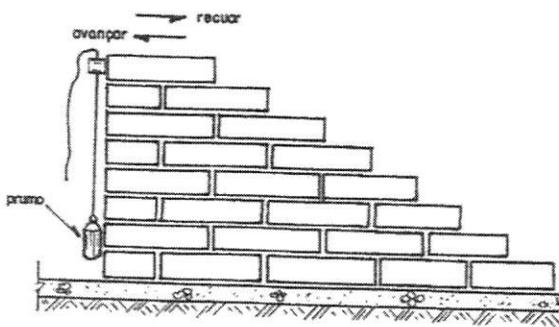
Figura 3 - Detalhe do prumo das alvenarias.
