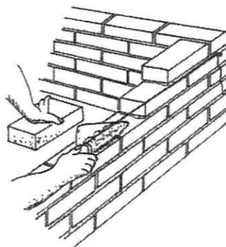
Figura 4 - Colocação da argamassa de assentamento
