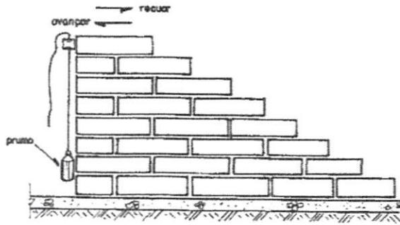
Figura 6 - Detalhe do prumo das alvenarias.
