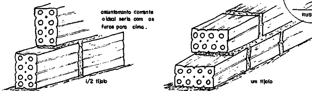
Figura 1 - Execução de alvenaria utilizando tijolos furados.
